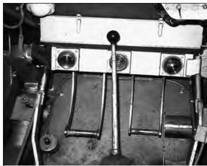
Le poste du pilote. De gauche à droite, le levier de direction gauche, l'embrayage, le levier de vitesses, le frein, l'accélérateur, le levier de direction droite
