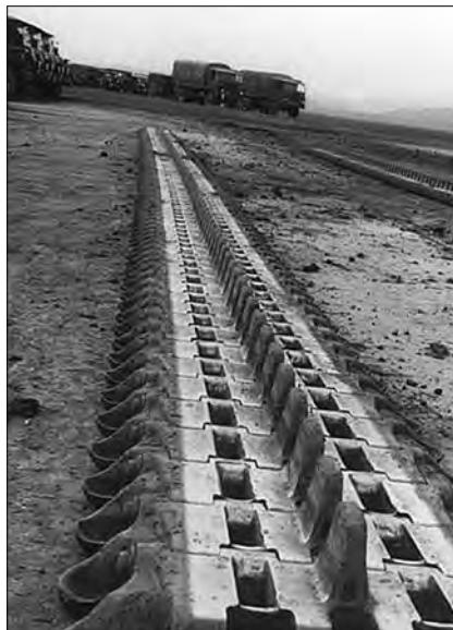
Les chenilles en acier sans coussinets en caoutchouc du Centurion provoquent des dégâts aux routes. Ainsi à Ouchy en 1967, lors de l'inauguration de la statue équestre du général Guisan
