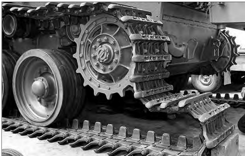
L'entretien, la réparation des chenilles, la remise en état d'un char qui a déchenillé sont des opérations pénibles qui nécessitent les forces des quatre hommes d'équipage
