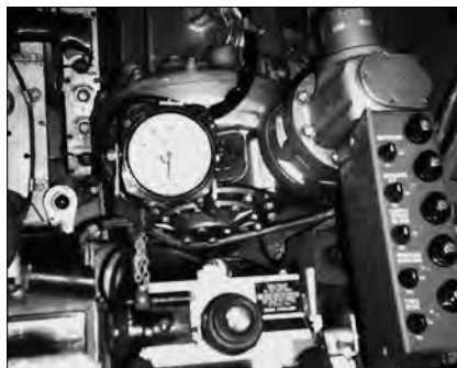
Le poste du pointeur avec, au centre, l'indicateur de dérive en pour mille, la lunette de visée.
